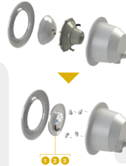
SETUP 1 Standaard Retrofit Oplossing
